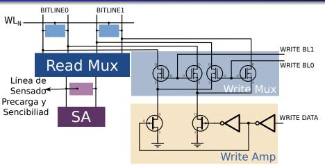
En este diagrama vemos el circuito completo del Amplificador de Escritura y lo integramos al resto de la estructura ya explicada para verlo de manera mas integral
