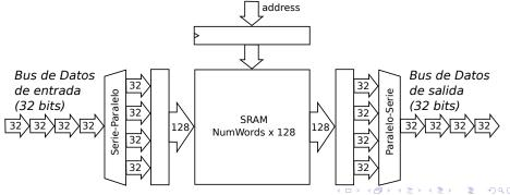
El principal concepto está en la interfaz de entrada y salida con el Bus de datos en la cual se realiza un trabajo de wrapping que permite comunicarse con los circuitos externos a una frecuencia mayor que la que se utiliza para acceder a la matriz de celdas (limitada por valores máximos tolerables de disipación de potencia).
