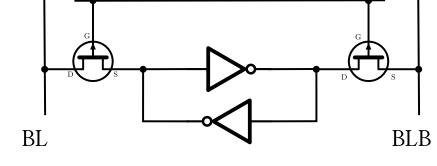
La escritura del bit se realiza activando **WL**, y colocando una tensión diferencial entre el par de Líneas de Bit (**BL**y **BLB**) proveniente de una fuente externa que fuerce el nuevo estado en el biestable.
