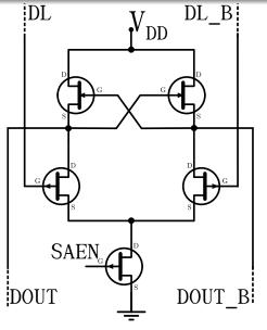
PMOS Cross Coupled Amplifier, provee alta velocidad de detección sin la corriente estática del Espejo de Corriente, (menor disipación de potencia estática).
