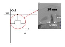
Almacena la información en forma de estado de carga en un capacitor y la sostiene durante un breve lapso con la ayuda de un transistor.
