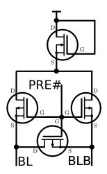
Usa un NMOS con para establecer una precarga de V<sub>DD</sub>-V<sub>t</sub>, combinado con transistores PMOS de paso para conectar las Bitlines solo durante la precarga.
