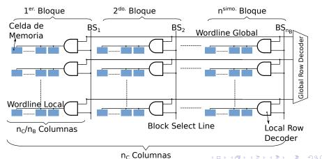
Las n<sub>C</sub> columnas del array de memoria se divide en n<sub>B</sub> bloques.
