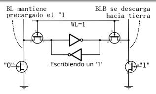
En NMOS de la derecha satura cuando se activa su Gate lo cual fuerza la línea BLB a Tierra. Esto hace que el NMOS de paso del lado derecho que tiene en WL un '1' sostenga el potencial 0 en BLB. El inversor fuerza un '1' en el Source del NMOS de paso izquierdo, y mantiene la precarga de BL dejando el biestable en este nuevo estado: BL = '1' y BLB = '0'
