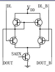
En general los amplificadores espejo de corriente ofrecen una salida muy estable, velocidad de detección y una alta ganancia de tensión.
