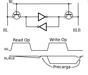
La mayor capacitancia de las Bitlines junto con la mayor corriente de salida del amplificador de escritura fuerzan la tensión diferencial y por ende el estado lógico en la celda.
