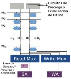
Se asume que todos los bitlines se precargan a una tensión predeterminada: V<sub>DD</sub>
