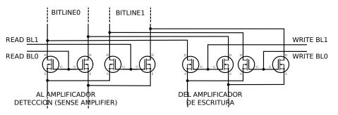
Para las escrituras una de las bitlines será descargada. Para esto se utilizan transistores NMOS Ya que al activarse pondrán en su salida un valor de tensión muy bajo lo cual significará un fuerte pull down.
