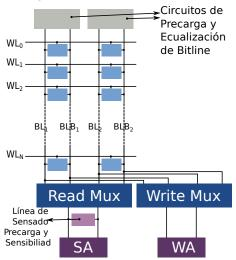
Un sistema de celdas para construir una SRAM requiere de un conjunto de lógica adicional.
