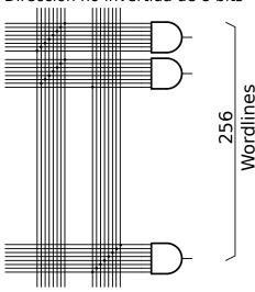
Si bien la configuración lógica es correcta, la capacidad de entrada de las AND de 8 entradas es mucho mayor que la de una AND simple de dos entradas.
