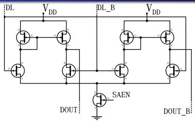
Pair Current Mirror Amplifier. Es un Amplificador espejo de corriente doble. Es una alternativa para duplicar las ventajas y las desventajas del anterior. No es apto para SRAMs de alta densidad.
