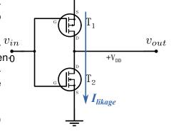
Y la Energía de leakage es el producto de la Potencia de leakage por el período de operación.
