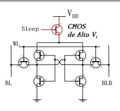
Logra disminuir la actividad del dispositivo (Potencia dinámica), ya que tampoco conduce, aunque tenga clock.
