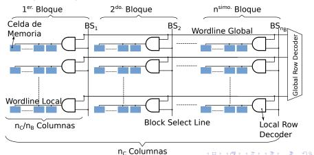
No se habilitan todas las celdas de una fila. En vez de esto, la GWL se "ANDea" con una Señal Block Select Line, proveniente de un subset de líneas de entrada, generando una Local Wordline (LWL). Solo se habilitan las celdas conectadas a esta LWL
