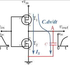
Finalizado el ciclo carga/descarga el CMOS y el capacitor movieron desde  $V_{DD}$  hasta tierra una cantidad de carga eléctrica igual a  $C.\Delta V$ . Esto significa que han utilizado una cantidad de Energía igual a  $C.\Delta V.V_{DD}$
