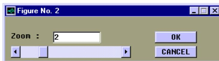
Para ello se deben definir dos **controles**, uno para el cuadro de edición y otro para la barra deslizable. Se usarán los **handles** **u2**, **u3** que determinan el cuadro de edición y la barra deslizante respectivamente.
