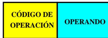
Fig. 16. Ejemplo de instrucción con direccionamiento inmediato
